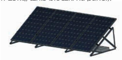
Rys.9 Osadzenie balastu (bloczków betonowych)
