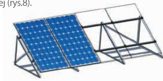
Rys.8, Montaż kolejnych paneli
